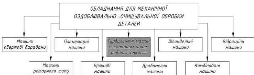
Рис. 12.1. Класифікація обладнання за конструкцією, для оздоблювально-зачищувальних процесів обробки деталей
