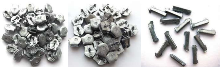
Рис. 11.2. Металеві деталі, які відділилися від ливників методом галтування
