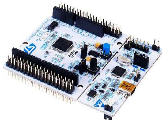
Рис. 2.42. Налагоджувальна плата STM32 Nucleo-F303RE
